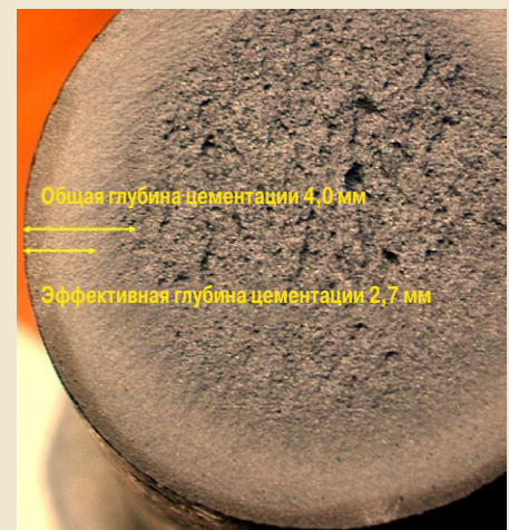
Рис. 4. Срез звена цепи ЗНХ диаметром 26 мм
