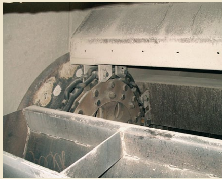
Рис. 6. Элеватор с цепями CISCА LH-C Ø 30 мм, предназначенный для транспортировки горячей сырьевой муки с температурой 200 °С с производительностью 600 т/ч при скорости движения цепей 1,5 м/с
