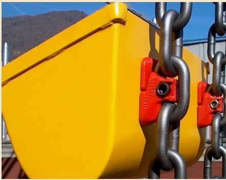
Рис. 5. Подвес ковша на креплениях типа ATS
