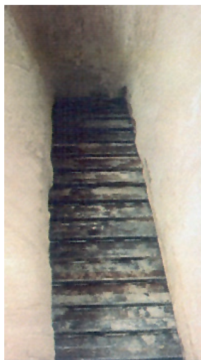
Trasportatore speciale a placche rinforzate Special conveyor with reinforced plates Verstärkter Sonderplattenförderer
