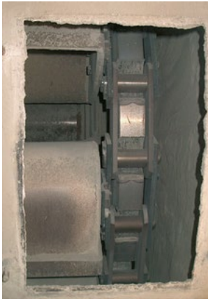
Catena smontabile; perni con testa Detachable chain with head pins Cadena desmontable; ejes con cabeza
